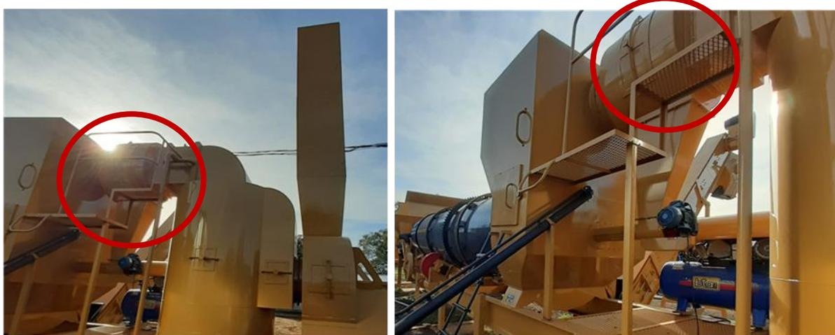
**Figura 26. Localización del Ciclón Directo en la Planta Asfáltica.**
