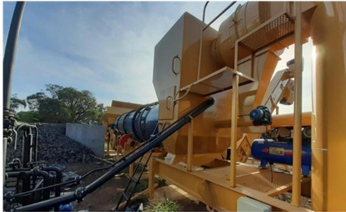
**Figura 13. Tubería de inyección de cemento asfáltico y de combustible desde el almacenamiento hacia el tambor.**
