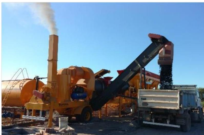
**Figura 16. Sistema de elevación redler y despacho de mezcla asfáltica.**
