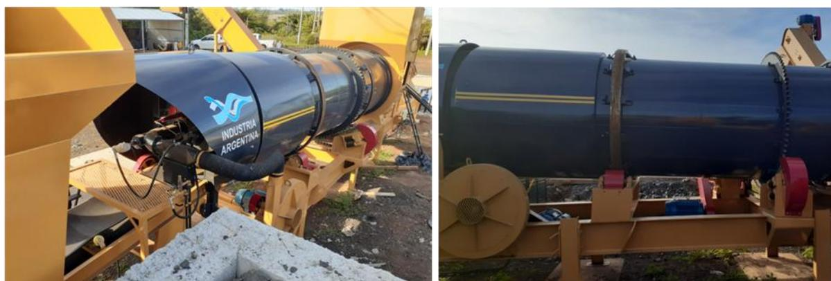
**Figura 12. Tambor Rotatorio de Secado y Mezclado.**
