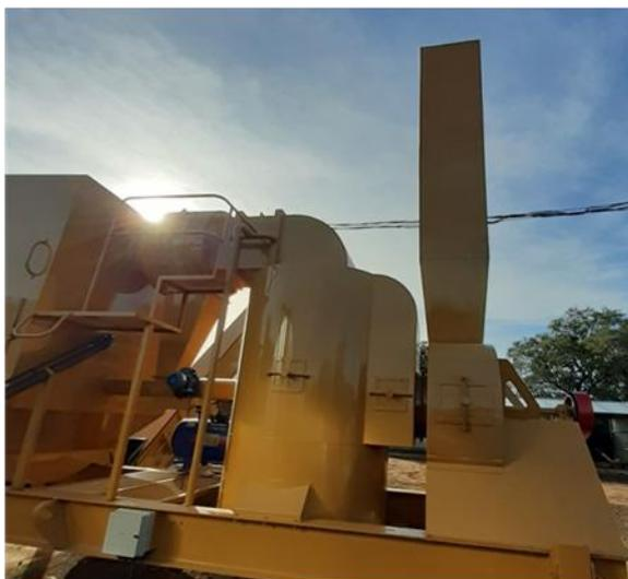
**Figura 15. Sistema de Captación y Depuración de Partículas.**
