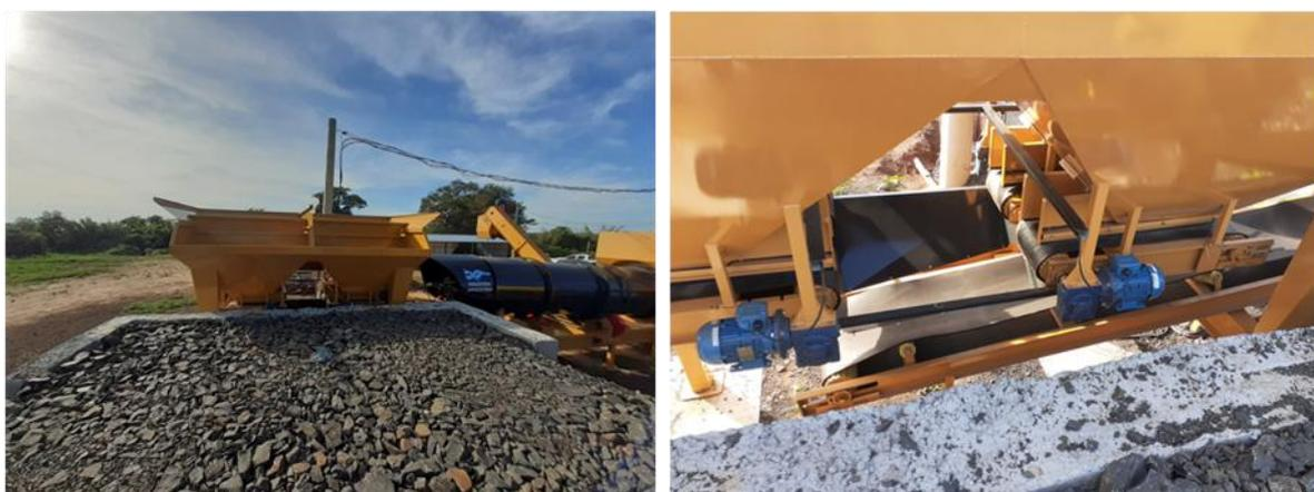
**Figura 11. Tolvas de alimentos de áridos en frío de la Planta Asfáltica.**
