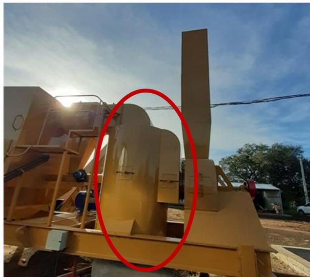
Figura 28. Localización del Lavador Húmedo en la Planta Asfáltica.
