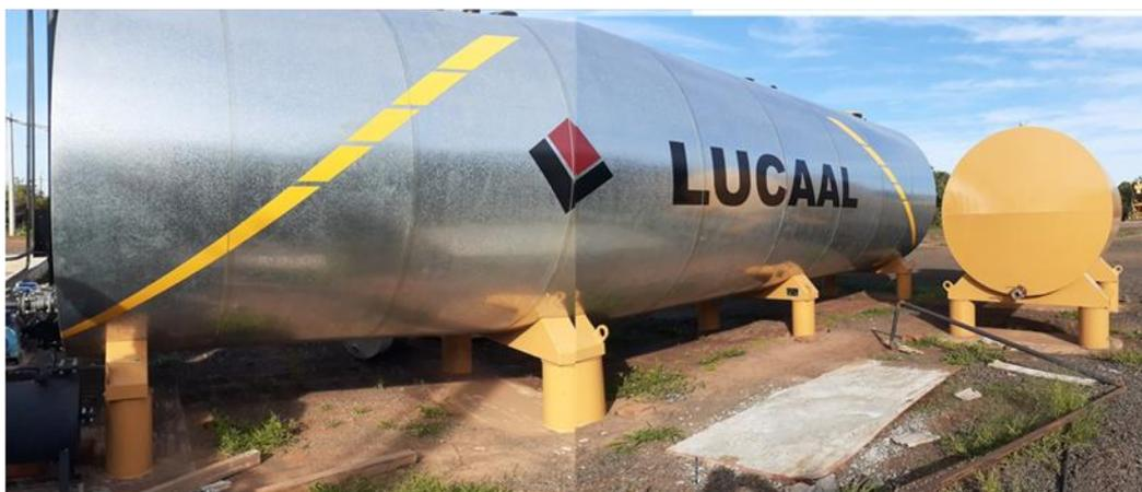
**Figura 4. Almacenamiento de Cemento Asfáltico (izquierda) y Combustible (derecha).**
