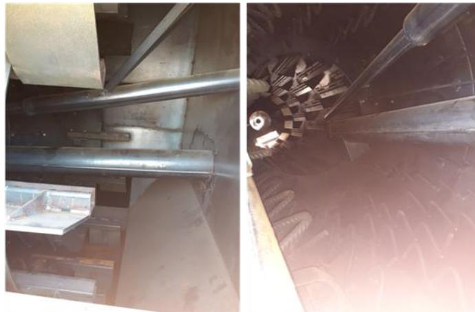
**Figura 14. Interior del Tambor Secador Mezclador.**
