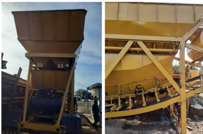
**Figura 18. Dosificación de áridos en la planta de hormigón.**
