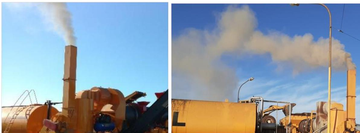
Figura 29. Lavador húmedo de gases. A la izquierda: con circulación de agua (Foto suministrada por el Proveedor). A la derecha: sin circulación de agua (Foto propia de plantas similares).
